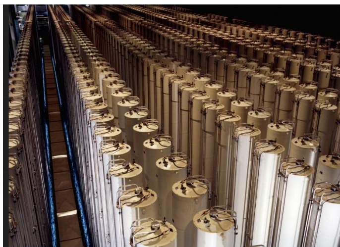
تصویر 7: برای ارتقای بهره دهی در پروسه غنی سازی باید صد ها سنتریفوژ در کنار هم قرار داده شوند.
